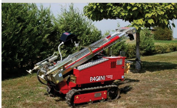
Figura 24 – Penetrometrica dinamico superpesante e statico da 20 ton
