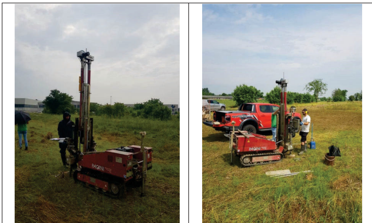
Figura 21 – Documentazione fotografica (sx = CPT; dx = DPSH)
